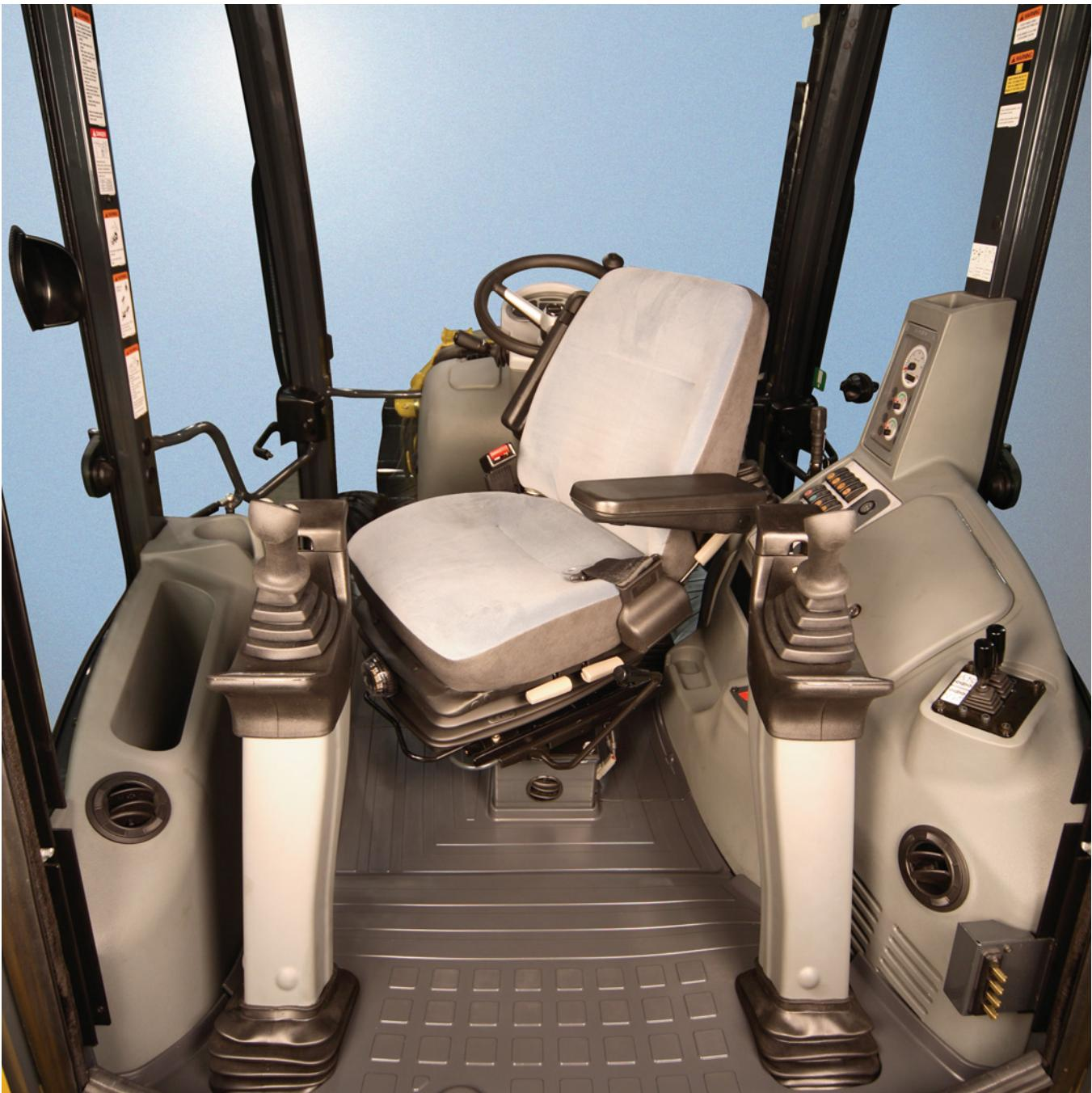
La estación del operador en la Guión-5 es de diseño de vanguardia. Los aditamentos interiores son robustos, pero a su vez elegantes. Los múltiples mecanismos de ajuste y control del asiento facilitan mayor comodidad tanto para operadores altos como bajos y les proporciona horas de operación confortable. La tolda o cabina dispone de una plataforma de entrada por ambos lados. La cabina con
